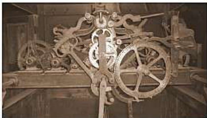
Mécanisme du carillon de la Rotonde
